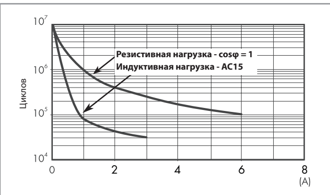
F 7S14 - Электрическая долговечность (AC) при ном. нагрузке - 7S.14/34
