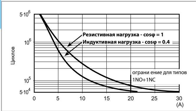
F 65 - Электрическая долговечность (АС) при ном. нагрузке
